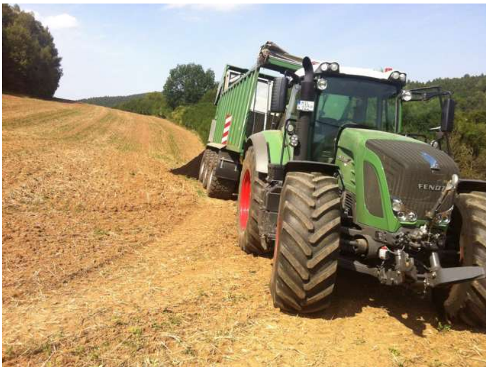
Abb. 11: Abladen mit landwirtschaftlichem Zug (Abschiebewagen) am/auf dem Feld auch bei schwierigen Boden- und Standortbedingungen – 1 (J. Wengert)
