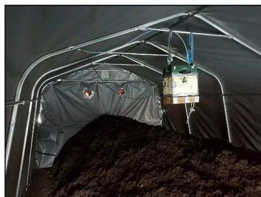
Abbildung 1: a) Versuchsaufbau und Nutzung des FID an einer Vergärungs-/Kompostierungsanlagen mit Dreiecksmiete b) Installierte Gaswaschflaschen für die nasschemische Analyse von  $NH_3$  (© DBFZ)
